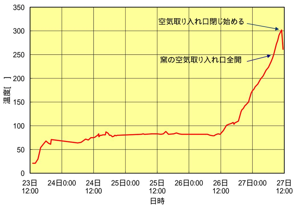
図 2-9 竹炭製造時の煙出口温度の変化
