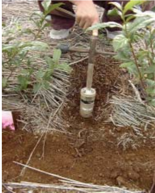
図 4-2 コアサンプラーによる土壌採取
